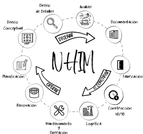
Figura 4.3: Disseny conceptual de les diferents fases del Model d'informació de Riscos Naturals (NHIM); basat en BIM, metodologia de treball col·laborativa per a la creació i la gestió d'un projecte de construcció. El seu objectiu és centralitzar tota la informació del projecte en un model d'informació digital creat per tots els seus agents. Crèdits: Adaptat de la Càmera Argentina de la Construcció.
