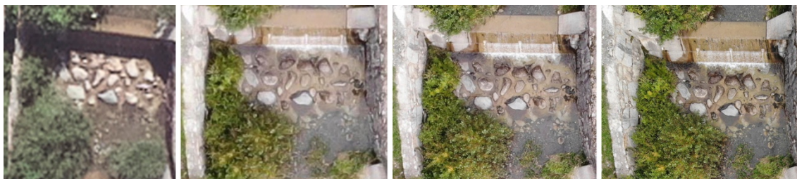
Figura 4.6: Comparativa de resolució d'imatges en una mateixa àrea: Ortofoto a color del Govern d'Andorra 2019 (10cm/ px ); vol dron a 120m d'alçada (6cm/ px ); 50m d'alçada (2cm/ px ) i 20m d'alçada (1cm/ px ). Crèdits: Elaboració pròpia.
